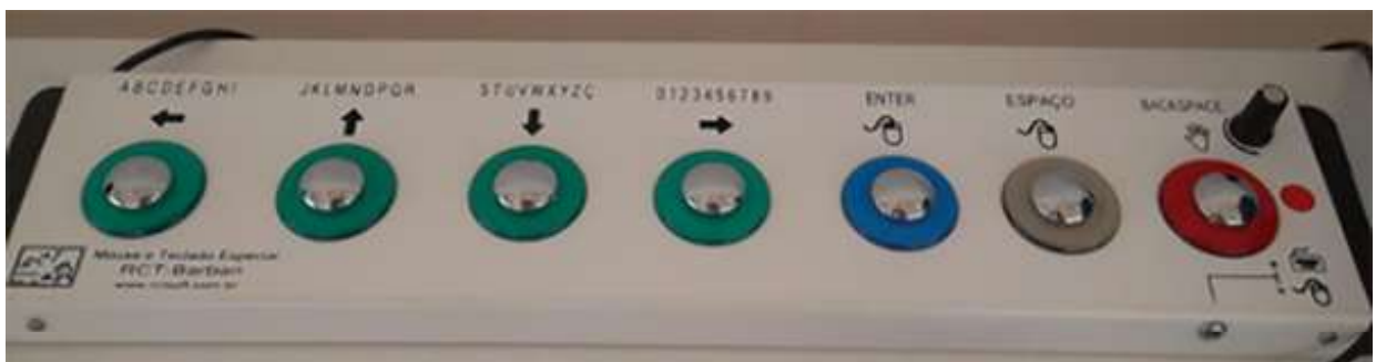
Figura 7 – Mouse e teclado RCT (substitui o uso do teclado e do mouse, funciona com o toque de qualquer parte da pele do usuário e não precisa de pressão).
