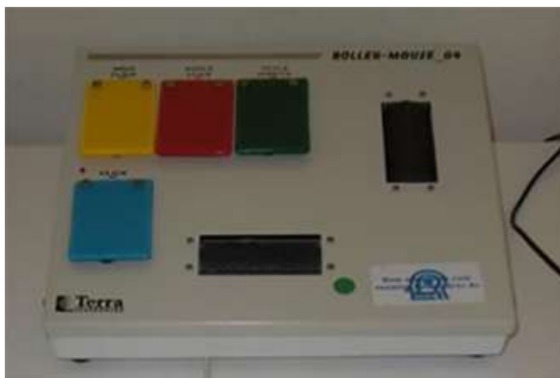
Figura 5 – Roller Mouse (substitui o mouse convencional, e as funções/botões poderão ser acionados com mãos ou pés).
