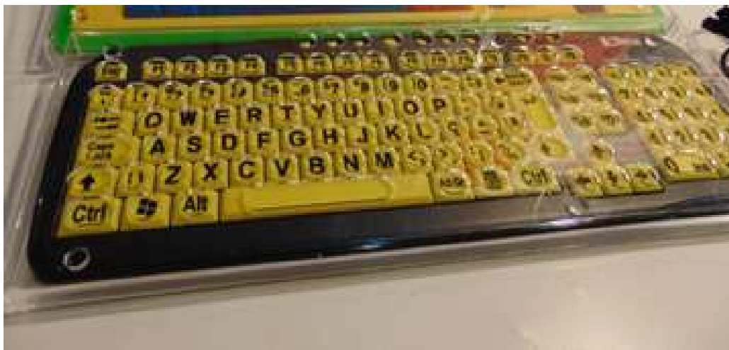
Figura 8 – Teclado com contraste e colmeia acrílica.
