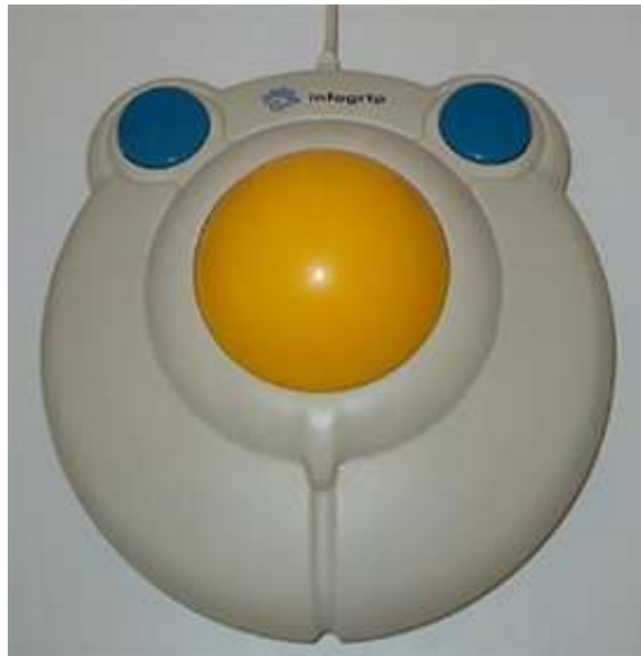
Figura 6 – BigTrack (substitui a função do mouse, facilitando seu manuseio).
