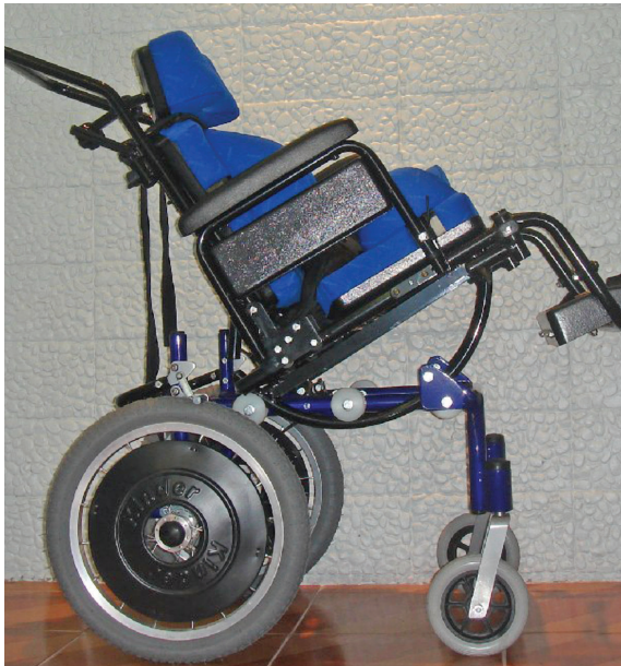
Foto 19 - Mostra uma cadeira de rodas infantil. Este modelo de cadeira possui TILT, ou seja, permite que a poltrona ou módulo postural, composto pelo assento, encosto, apoio de cabeça e de pés, possa ser rebatido para trás e fixado em várias posições.
